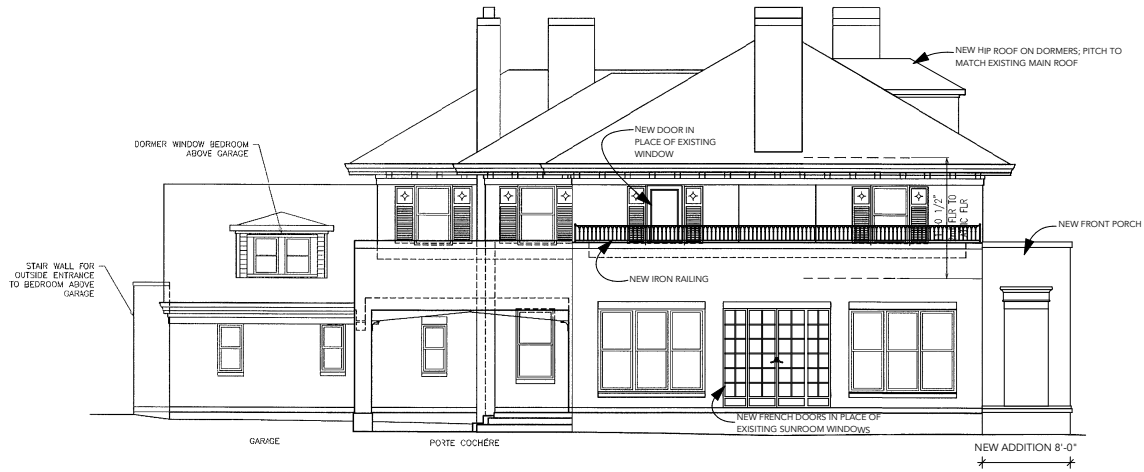
1 LEFT ELEVATION SCALE: 1/8" = 1'-0"
