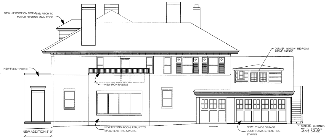
2 RIGHT ELEVATION SCALE: 1/8" = 1'-0"
